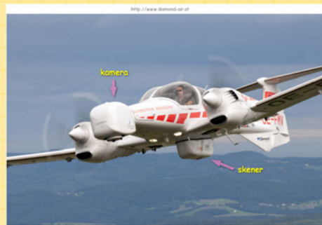
obr. : letecké snímkování + letecké laserové skenování (lidar)
